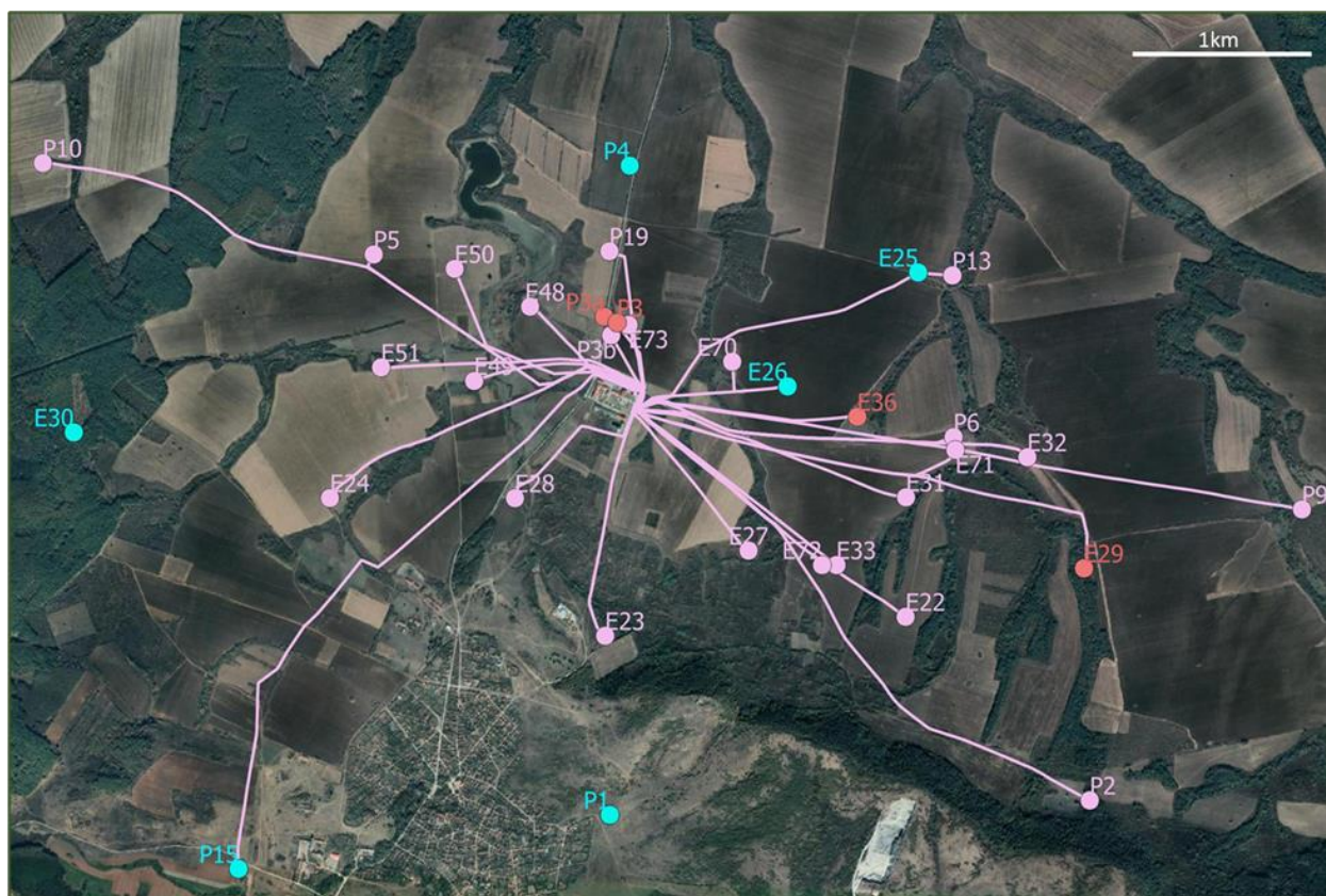
Фигура 3. Съществуващи сондажи и конфигурация на инфраструктурата на ПГХ Чирен
