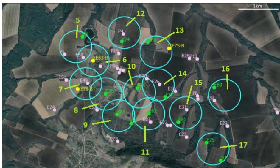
Фигура 2. Местоположение на експлоатационни и наблюдателни сондажи (10 нови експлоатационни, 3 наблюдателни и 3 допълнителни сондажа) - оптимизирани параметрите на ИП
